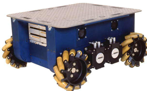
Figura 4: Ejemplo de robot con ruedas Mecanum instaladas
