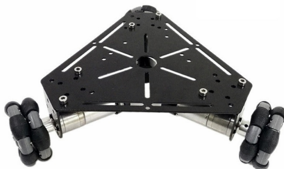
Figura 2: Ejemplo de distribución geométrica útil para ruedas omnidireccionales
