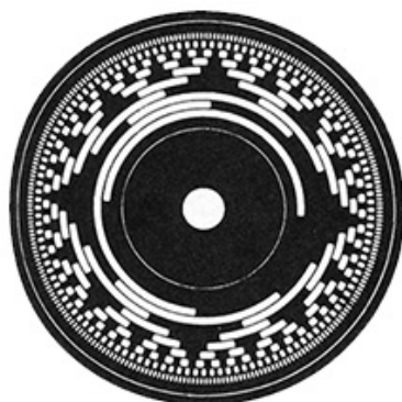
(a) Disco perforado para encoder óptico capaz de medir posición angular
