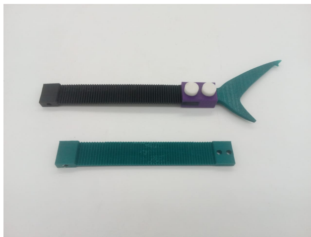
FIGURA 1. Conexión entre las aletas impresas y el motor
